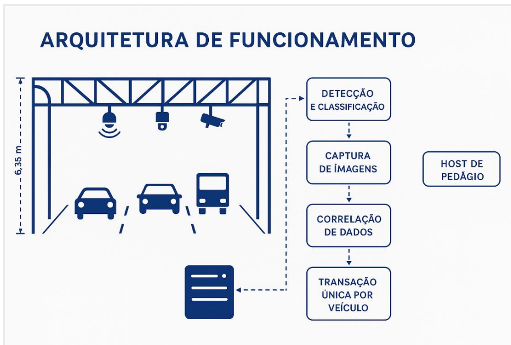
Figura 5 – Esquemático da arquitetura de funcionamento do pórtilo
